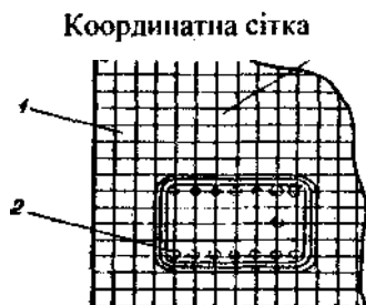
Рис. 3.27. Розміщення корпусних мікросхем зі штирковими виводами (2) на печатній платі зі стандартною координатною сіткою (1)
