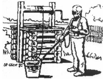
Рис. 4.10. Визначення ступеня радіоактивного зараження (забруднення) джерела водопостачання
