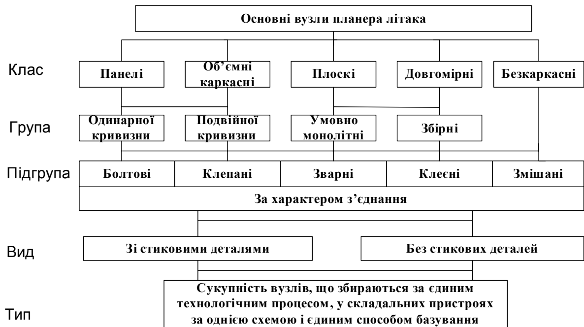
Рис. 3.4. Принципова схема класифікації основних вузлів планера літака
