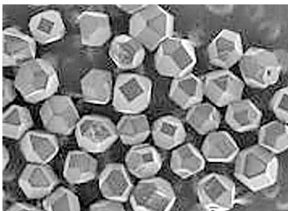
Рис. 2. Світлина наноалмазів з діаметром 6 нм [24]
