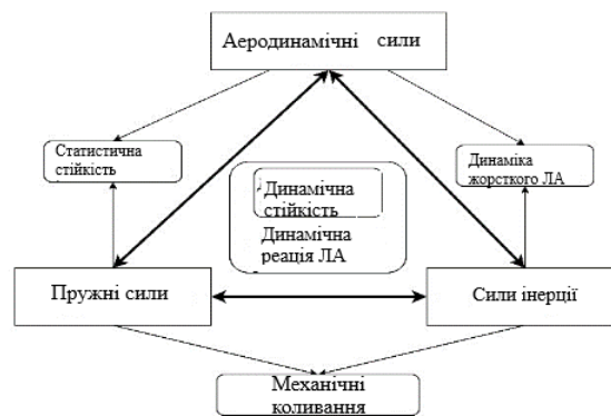
Рис. 12.1 - Взаємодія аеродинамічних, пружних та інерційних сил
