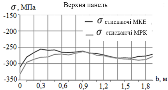
Рис. 7.2.3 - Розподіл напружень у перерізі \bar{z} = 0.1
