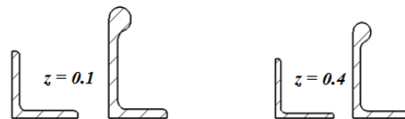
Рис. 6.1.3 - Стрингерний набір для стиснутих і розтягнутих зон перерізів крила
