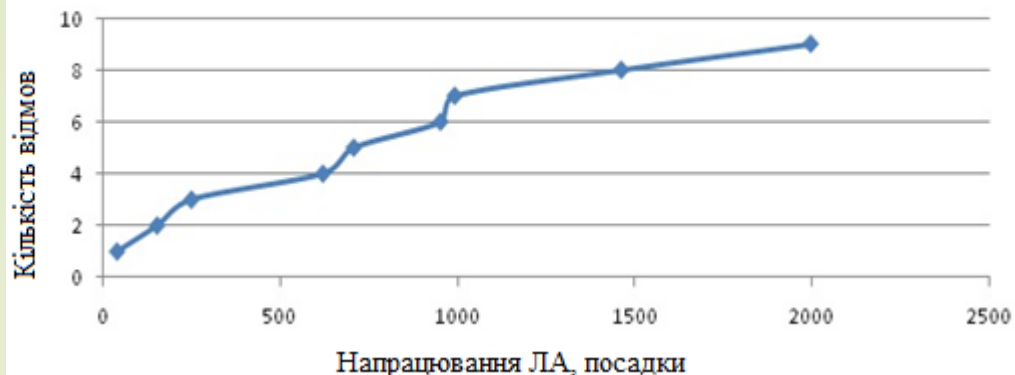
Відмови насосної станції від напрацювання за кількістю посадок
