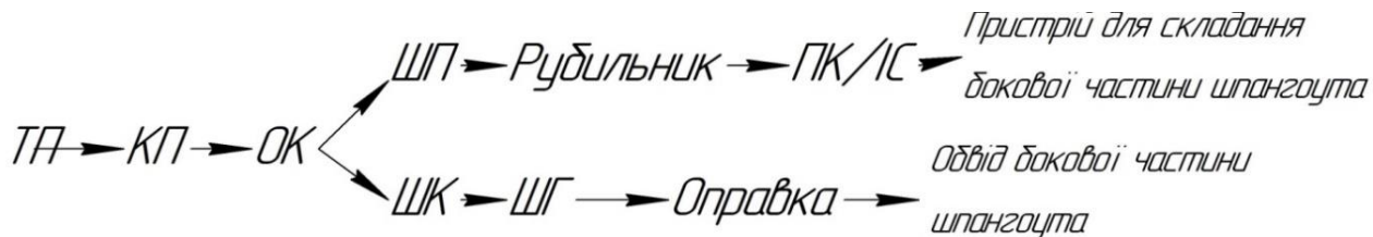
Рис. 2.4. Схема ув'язки пристрою для складання бокової частини шпангоута і виготовлення деталі (обода бокової частини шпангоута) при КШМ
