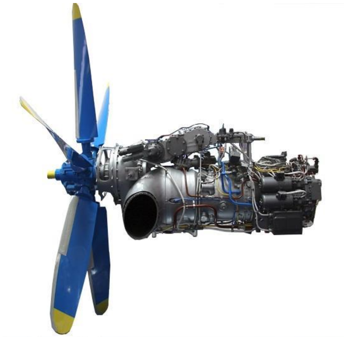
Рис. 1.7. Схема двигуна ТВД-20Б
