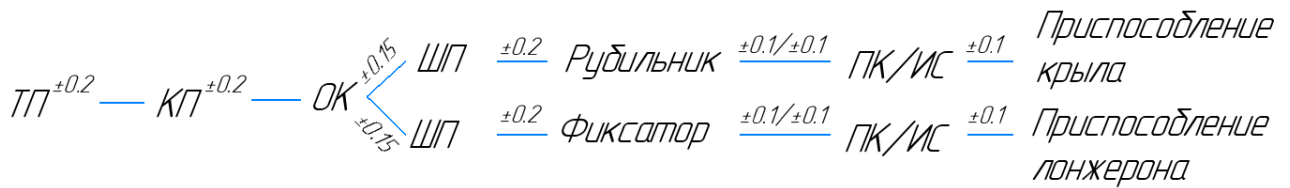
Рис. 2.2. Структурна схема ув'язки пристрою стабілізатора і пристрою заднього напівлонжерона при координатно-шаблонному методі.
