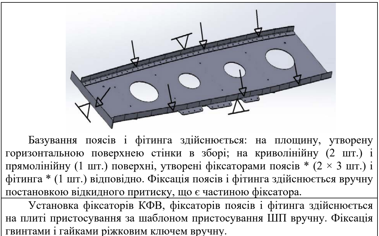
Продовження таблиці 2.1 – Схема базування складових частин нервюри
