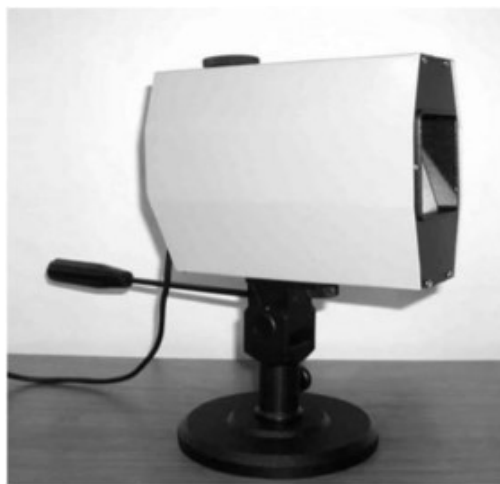
Рисунок 1.9 – Загальний вигляд тепловізора ТВ-04 «Кст»
