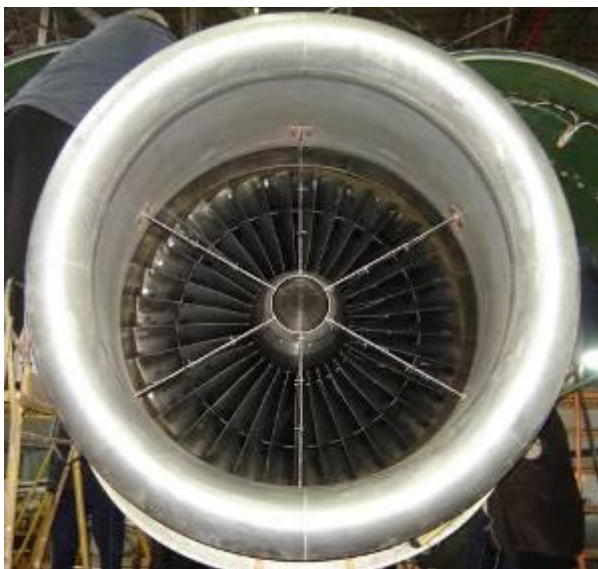
Рисунок 2.2 – Установлення гребінок приймачів тиску у повітрязбірнику ( a ) і соплі вентиляторного контуру двигуна ( б )
