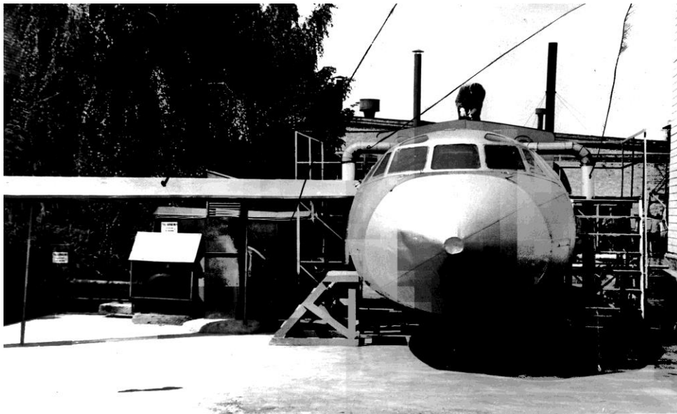
Рисунок 3.13 – Загальний вигляд стенда ВКВ літака Ан-72
