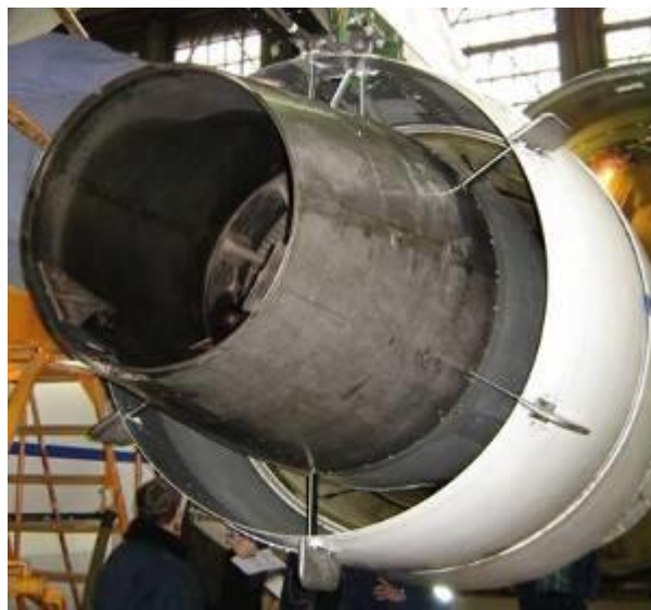
Рисунок 2.2 – Установлення гребінок приймачів тиску у повітрязбірнику ( a ) і соплі вентиляторного контуру двигуна ( б )
