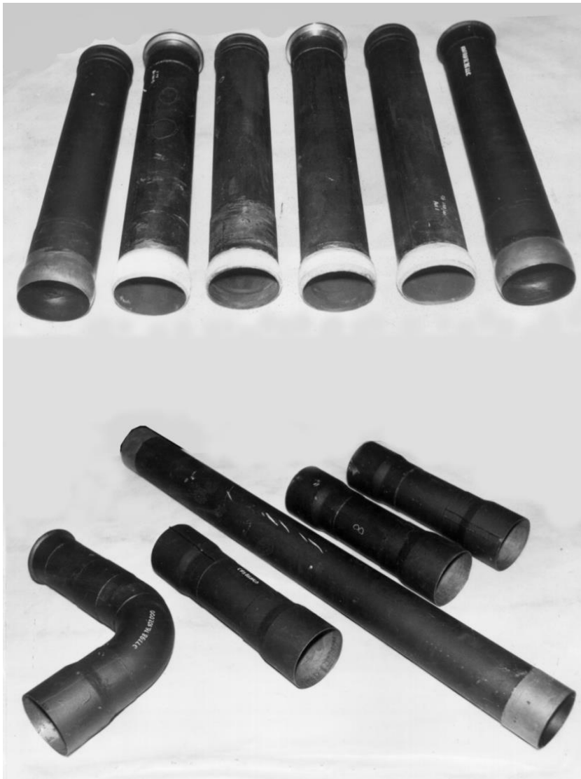
Рисунок 4.30 – Об'єкти випробувань: конструктивні елементи повітряних мереж із ПКМ
