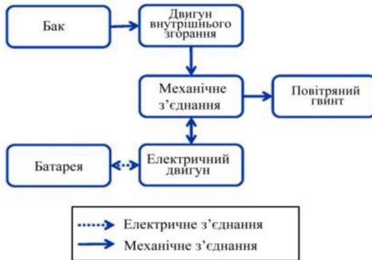
Рисунок 7.40 – Приклад використання паралельної схеми гібридної маршової силової установки
