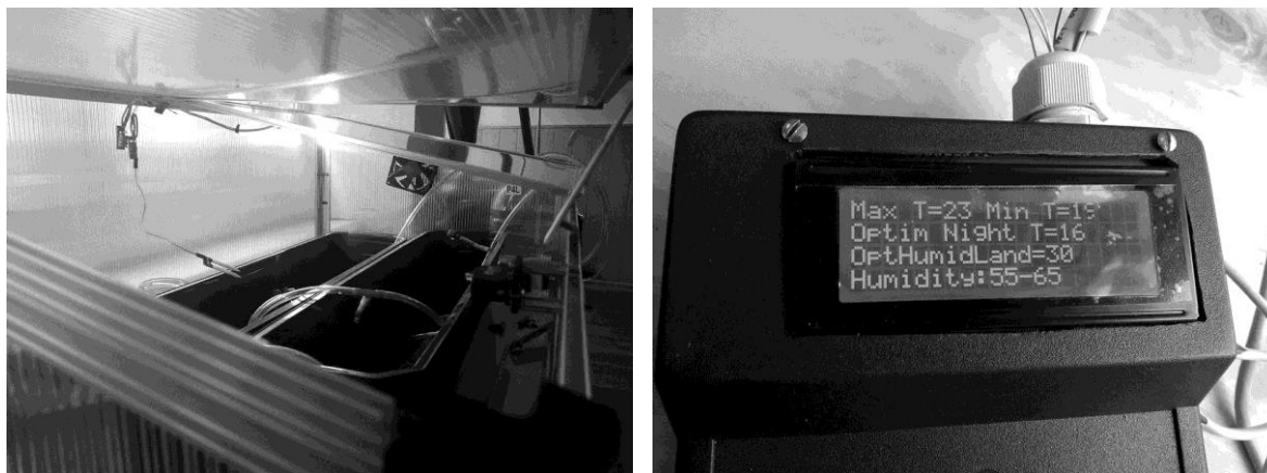
Рисунок 1 – Створений лабораторний макет системи контролю та управління тепличним господарством
