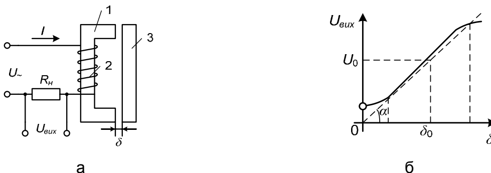
Рис. 2.9. Електрична схема однопотактного індуктивного датчика (а) і його статична характеристика (б)
