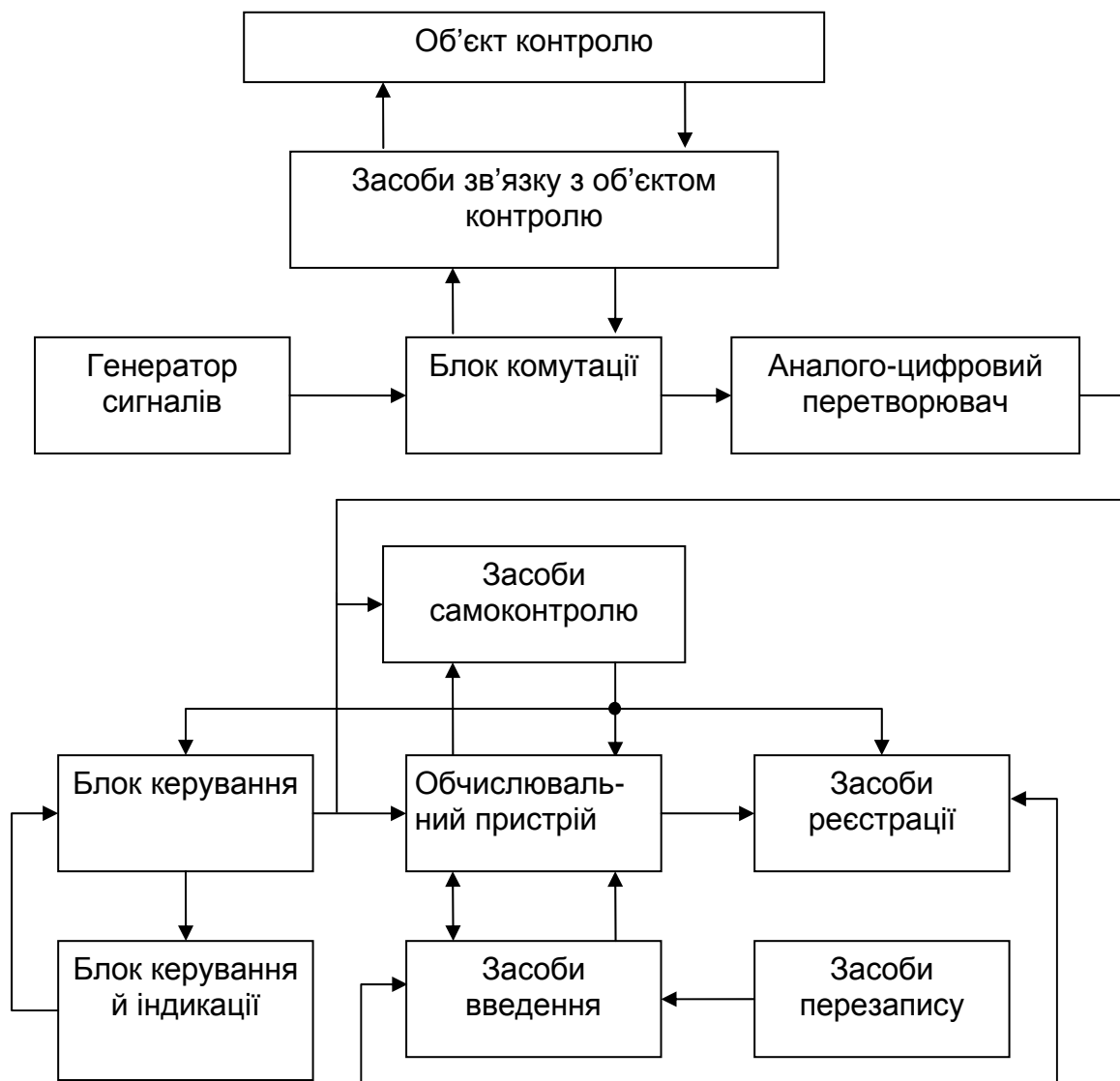
Рис. 1.6. Блок-схема АСК для контролю радіоелектронних засобів
