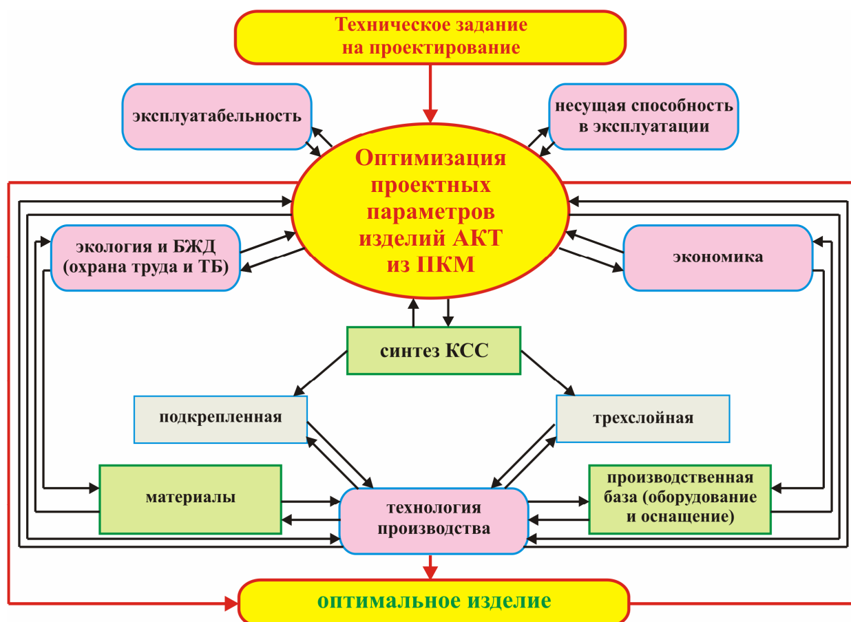
Рисунок 1 – Укрупненная блок-схема концепции оптимизации проектных параметров ГО из ПКМ
