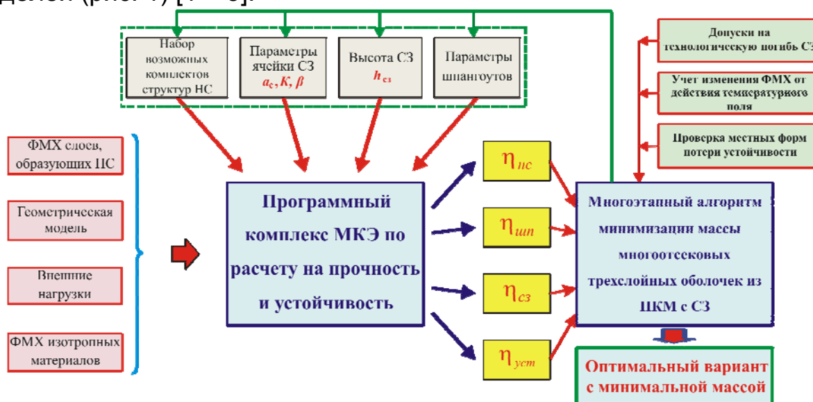
Рисунок 1 – Концепции и комплексный подход к минимизации массы многоотсековых трехслойных оболочек из ПКМ с СЗ в программном комплексе МКЭ
