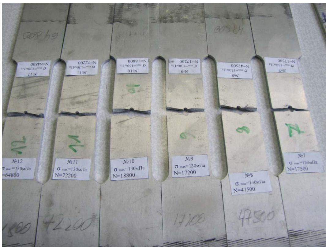
Рисунок 2 – Типичный характер разрушения образцов различных партий
