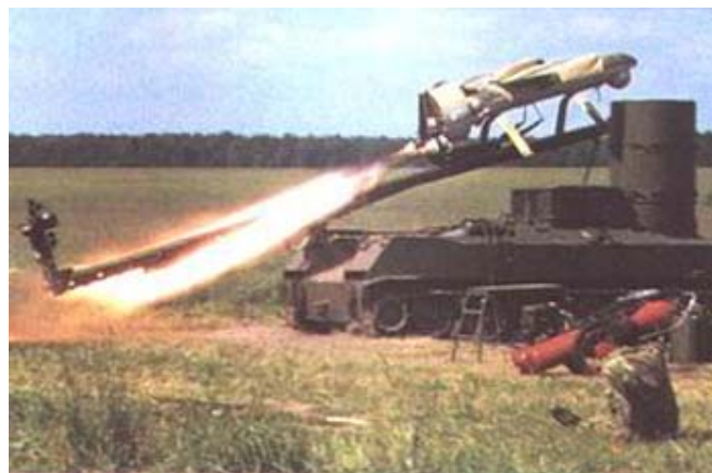
Рисунок 1 – Старт БЛА «Пчела» с помощью реактивной тележки
