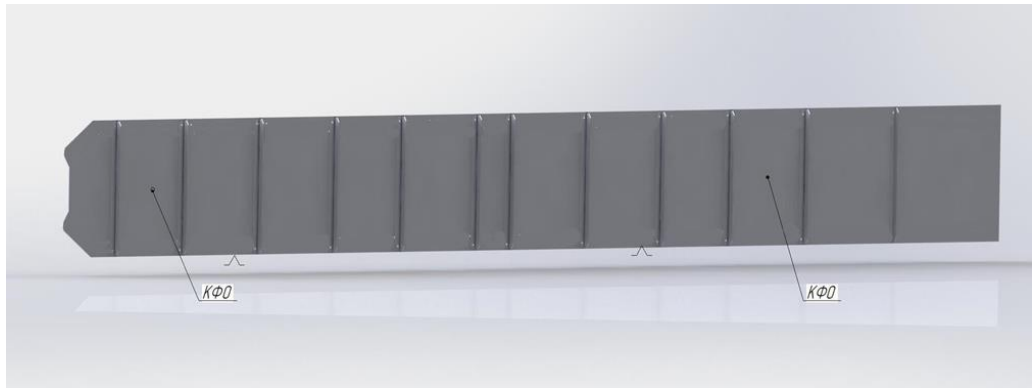
Рисунок 2.7 – Схема базування стінки із встановленими на ній стійками
