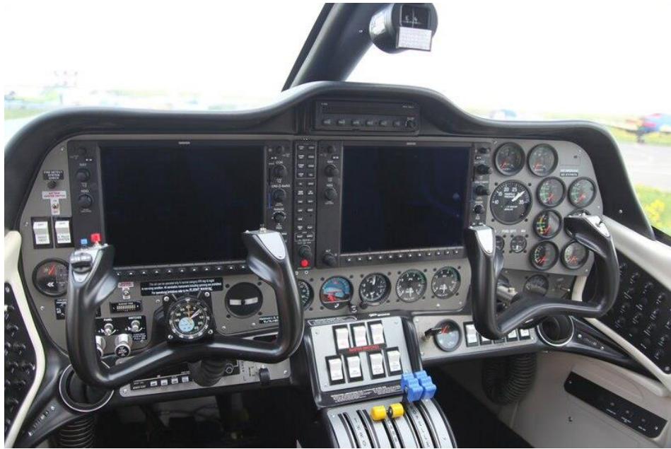
Рисунок 1.23 – Вигляд кабіни з комплексом Garmin-1000
