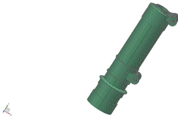
Рисунок 4.3 - Розбивка моделі на сітку Проводимо закріплення циліндра і прикладаємо навантаження
