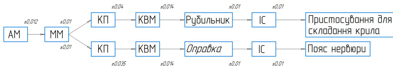
Рисунок 26 – Структурна схема ув'язування складальних пристосувань і пояса нервюри при ПІМ
