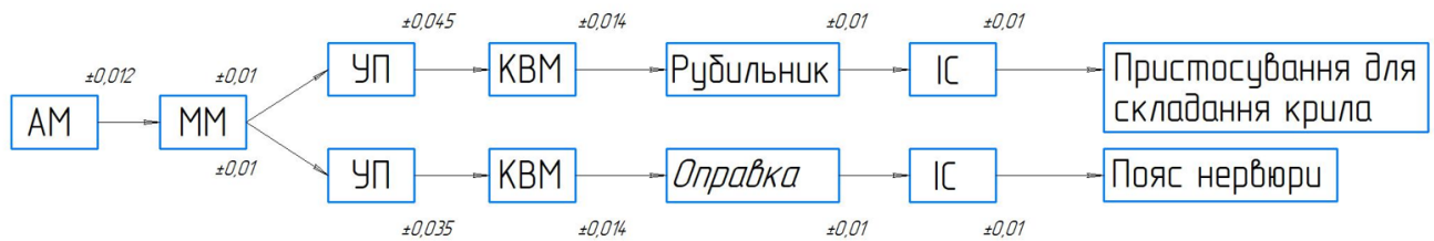
Рисунок 27 – Структурна схема ув'язування складальних пристосувань для переднього лонжерону крила та пояса нервюри згідно з програмно-інструментальним методом.
