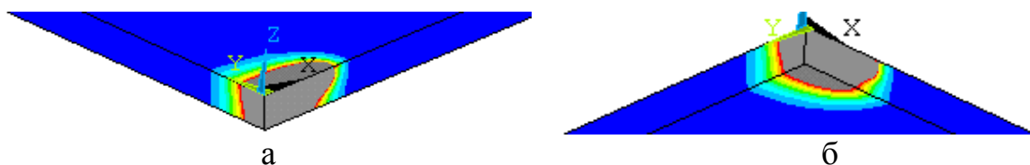
Рисунок 2.10 – Ширина різку на верхній (а) та нижній (б) площинах пластини при різанні сталі X18H10T (товщина 2 мм, швидкість 10 мм/с)
