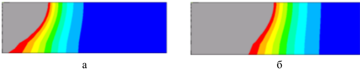
Рисунок 2.7 – Етапи повного розрізання пластини товщиною 4 мм при швидкості різання 5 мм/с: а – через 0,4; б – через 0,9 с
