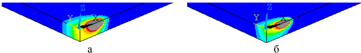
Рисунок 2.12 – Результати моделювання лазерного різання листа зі сталі 45 товщиною 2 мм при різанні з різними швидкостями: а – 20 мм/с; б – 50 мм/с
