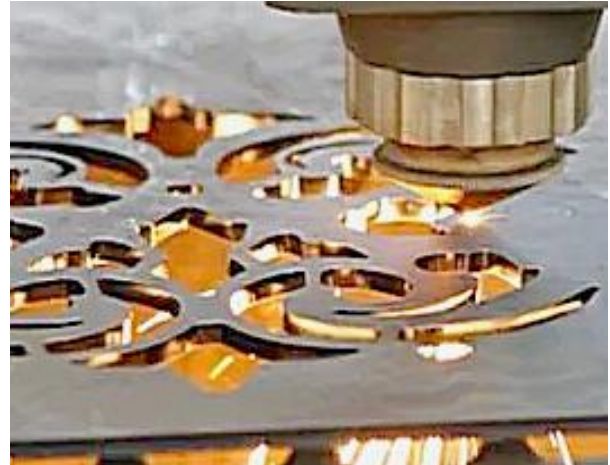
Рисунок 1.9 - Приклад реалізації розмірної точності лазерного різь
