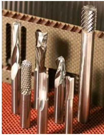
Рисунок 4.1. Зображення прикладів інструментів для механічної обробки ПКМ [114]
