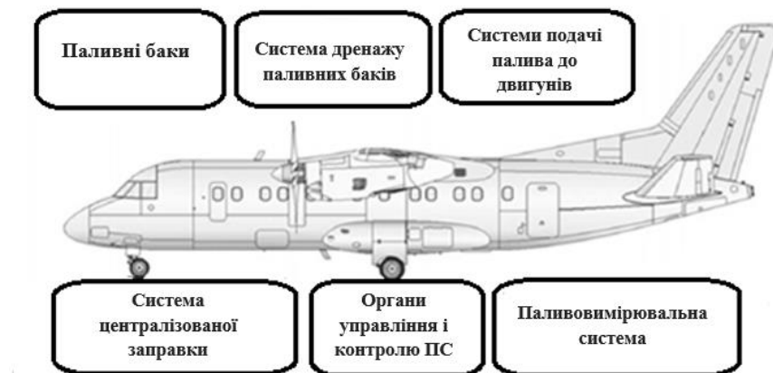
Рисунок 1.2 – Склад паливної системи літака АН-140
