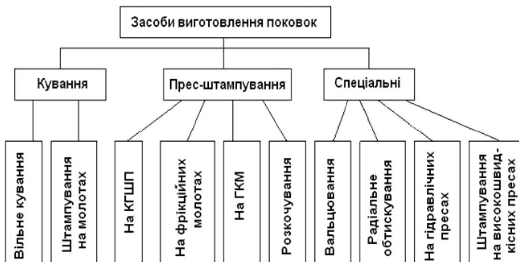
Рисунок 2.6 – Основні способи об'ємної деформації в авіаційній промисловості
