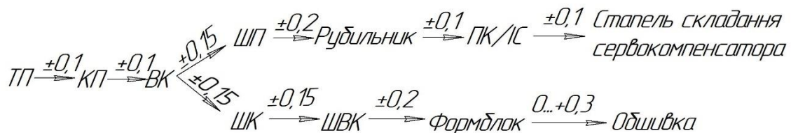
Рисунок 2.3 – Структурна схема ув'язування СЧ та ЗТО для складання сервокомпенсатора елерону при ПІМ
