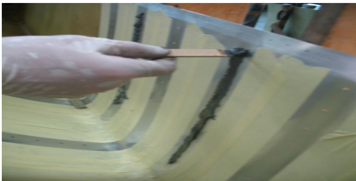
Рисунок 4.3 Нанесенням герметика на обшивку
