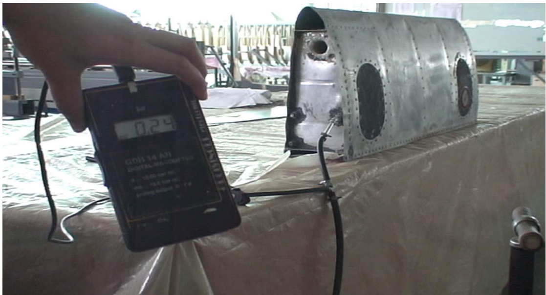
Рисунок 4.5 а), б) перевірка на герметичність паливного бака
