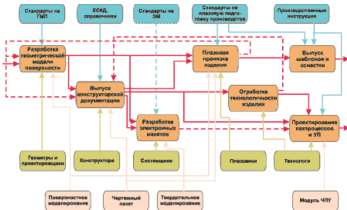
Рисунок 1.2 – Схема інформаційних потоків при плазовій підготовці виробництва [3, 5]
