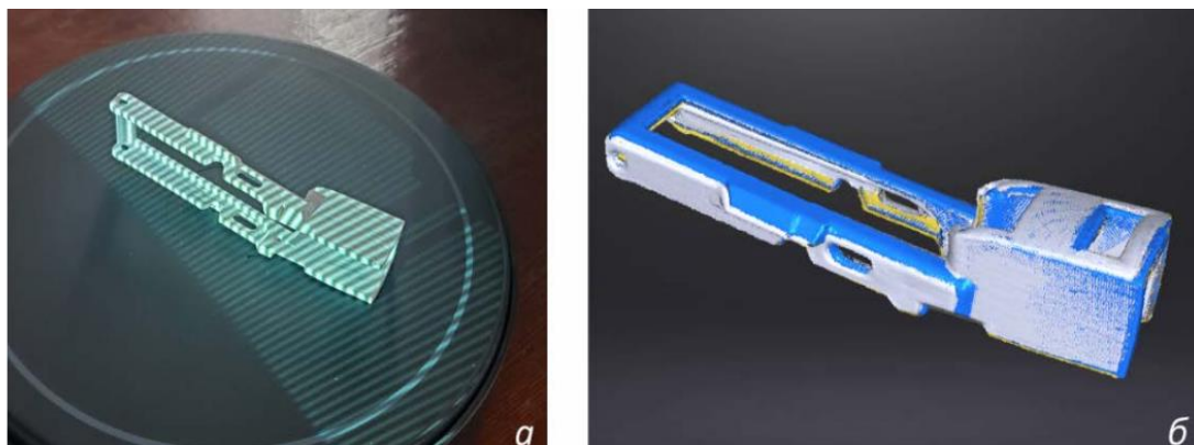
Рисунок 4.6 – Результат сканування деталі після матування поверхні
