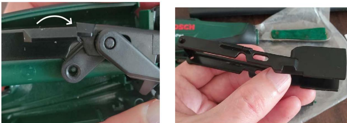
Рисунок 4.4 – Важіль подачі клейового пістолету (місце руйнування)
