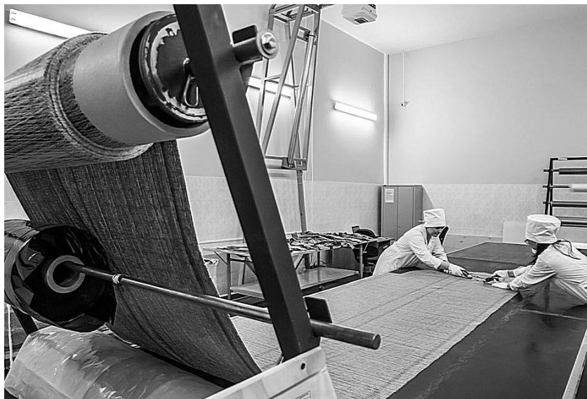
Рисунок 4.3 – Розкроювання тканини з використанням лазерного проектора
