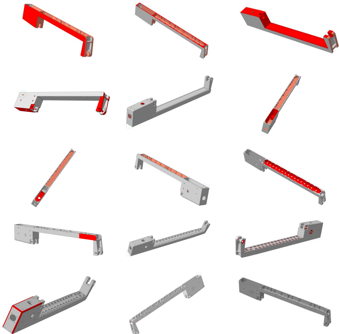
Рисунок 2.3 - Комп'ютерні моделі етапів виготовлення деталі «Балка»
