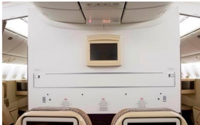
Рис. 4.18 - Надрукована на 3D-принтері рамка телевизора, встановлена Etihad Airways на одному зі своїх літаків [Зображення: Etihad Engineering]
