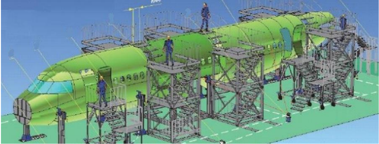
Рисунок 1.3 – Приклад стикування відсіків фюзеляжу Ан-148
