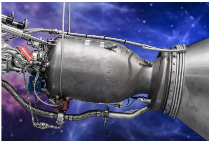
Рис. 4.14 - Ракетний двигун Orbex, надрукований на 3D-принтері [Зображення: Orbex]
