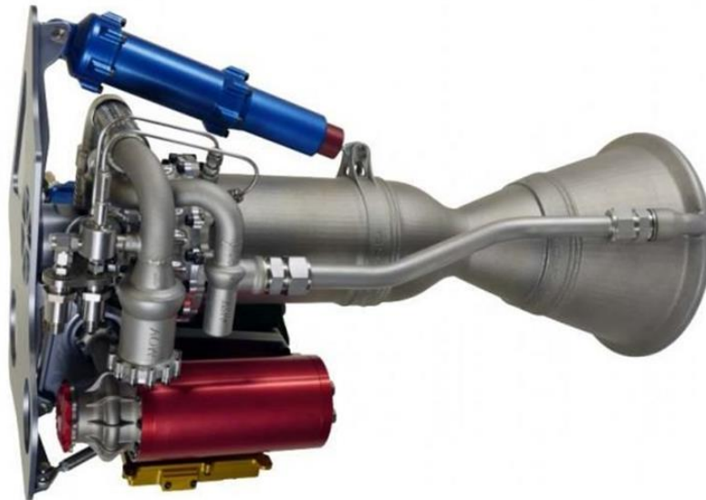
Рис. 4.13. -Двигун Резерфорда надрукований на 3D-принтері [Зображення: Rocket Lab]
