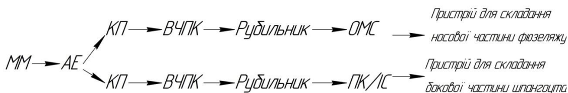
Рис. 2.1. Структурна схема ув'язки СП носової частини фюзеляжу і СП бокової частини шпангоута при МКАУ
