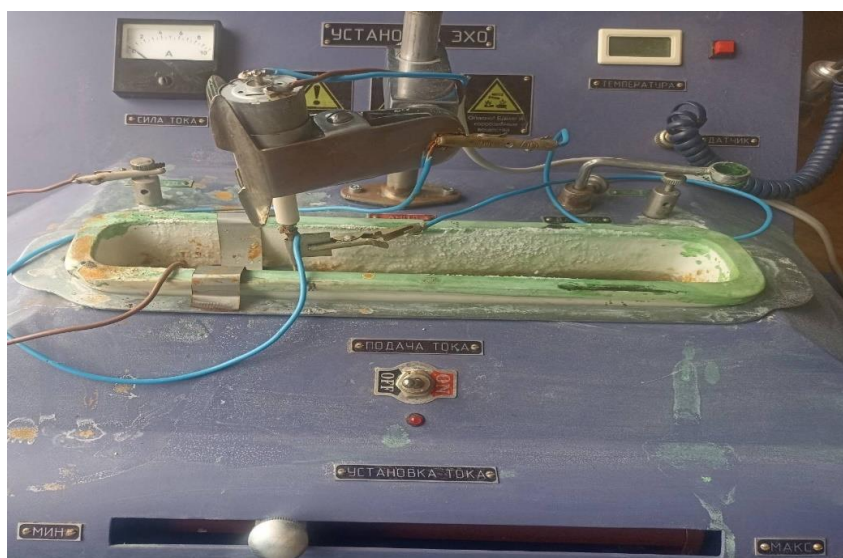
Рис 4.3. Установка для електрохімічної обробки деталей моделі ЕЗІ-2М
