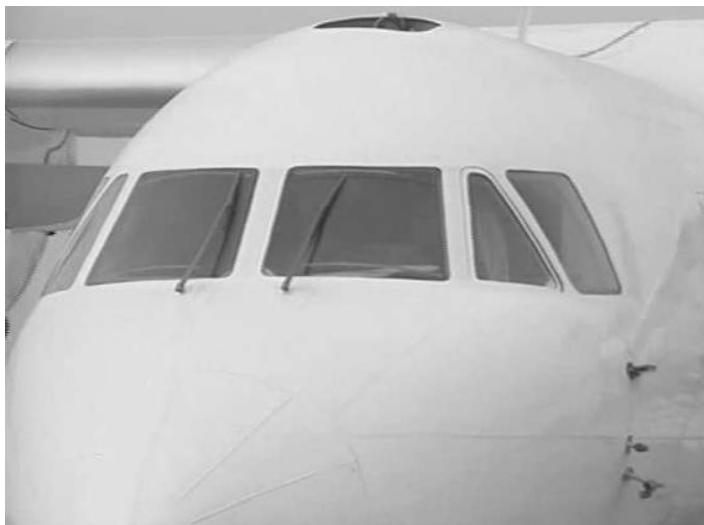
Рис. 1.2. Лобове скло носової частини фюзеляжу Ан-140 [1].
