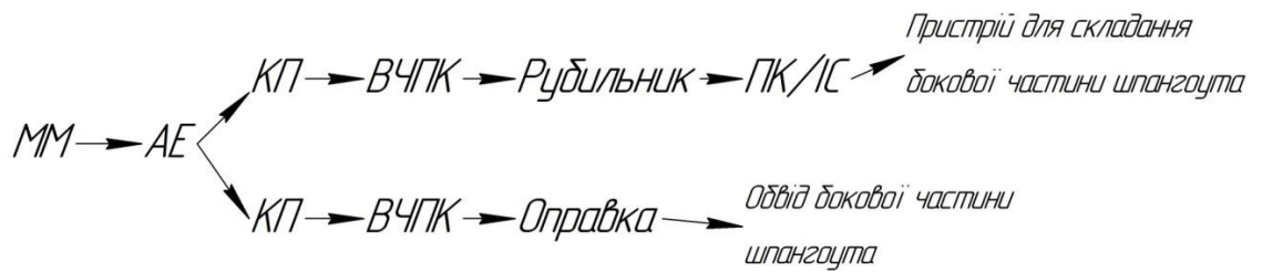
Рис. 2.3 – Схема ув'язки пристрою для складання бокової частини шпангоута і виготовлення деталі (обода бокової частини шпангоута) при МКАУ.
