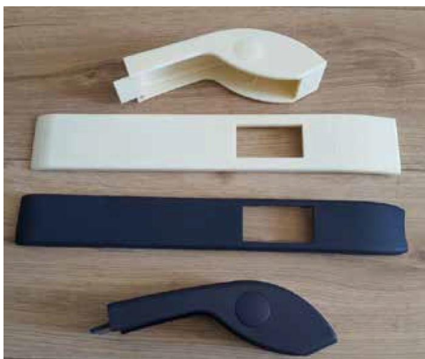
Рисунок 3.2 – Деталі підлокітника крісла пасажирського салону літака EMBRAER
