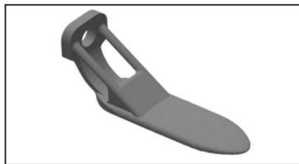
Рисунок 4.3 – Оптимізований за масою кріпильний виріб, отриманий за допомогою адитивної технології
