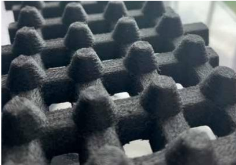
Рисунок 2.8 – ЗТО з високим показником шорсткості, не придатне для виготовлення пористого заповнювача
