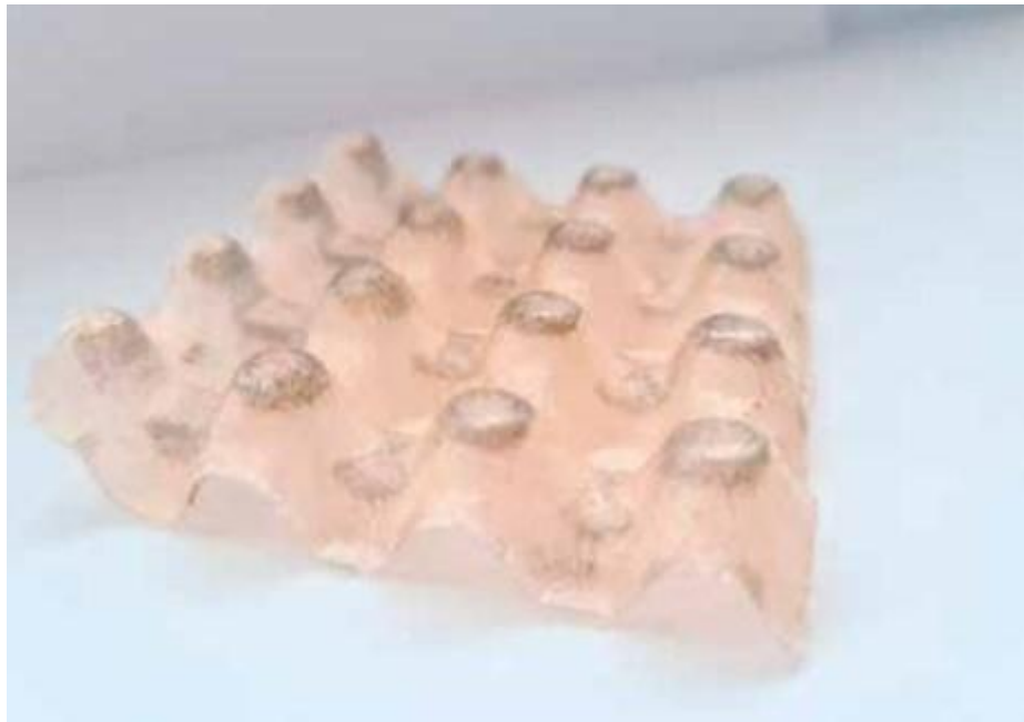
Рисунок 2.5 – Пористий комірчастий заповнювач, виготовлений із застосуванням адитивних технологій
