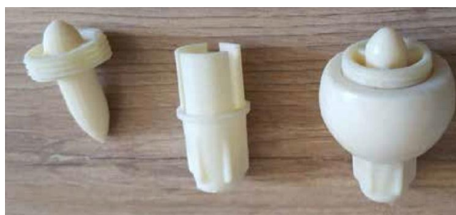
Рисунок 3.3 – Повітряний кран індивідуального обдування (салон літака Як-42)
