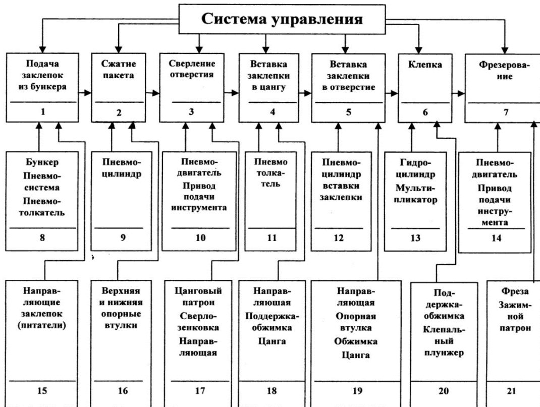
Малюнок 4.5 - Функціонально-структурна схема СКА: 1-7 - системи СКА; 8-9 - виконавчі механізми СКА; 15-21 - оснащення і інструмент.
