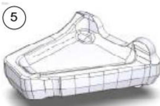
Рисунок 1.2 – Етапи реінжинірингу промислового виробу: а – виріб; б – хмара точок; в – вихідна триангуляційна модель; г – триангуляційна модель після редагування; д – модель з NURBS- поверхнею; е – CAD-модель [2]
