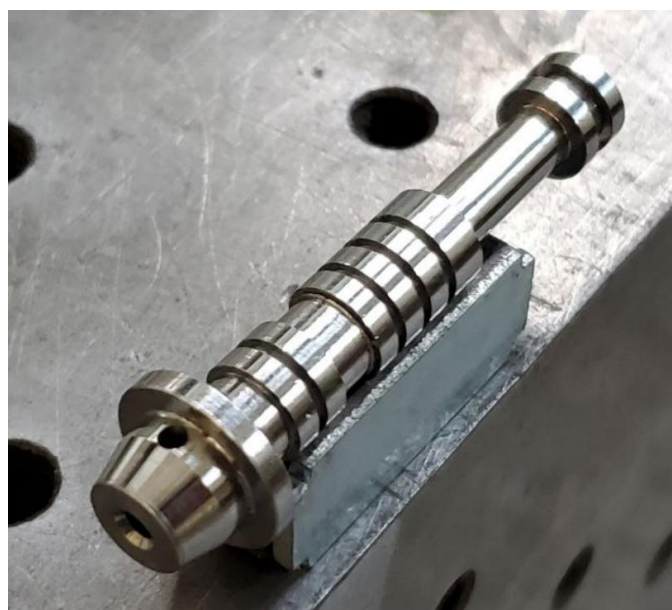
Рисунок 2.13 – Золотник плунжерної пари авіаційної гідросистеми зі зношеною зовнішньою поверхнею
