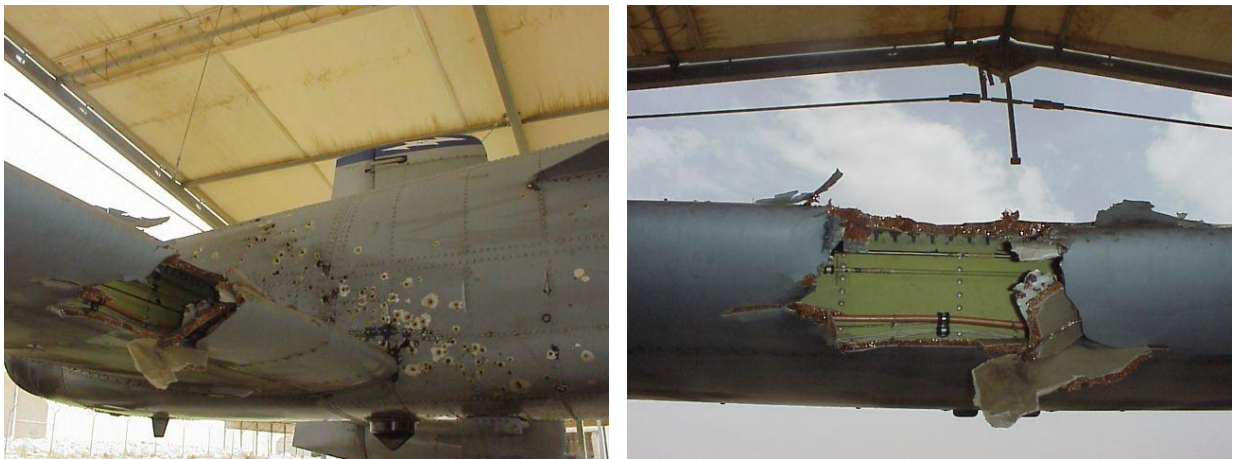
Рисунок 2.9 – Приклад пошкодження композитної передньої кромки стабілізатора літака
