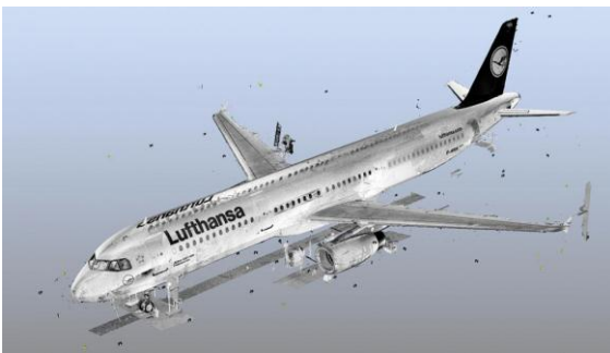
Рисунок 1.11 – Літак авіакомпанії Lufthansa: а – одержання хмари точок; б – реконструкція 3D-моделі [10]
