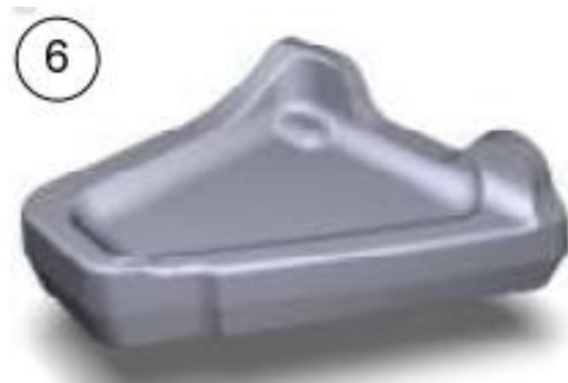
Рисунок 1.2 – Етапи реінжинірингу промислового виробу: а – виріб; б – хмара точок; в – вихідна триангуляційна модель; г – триангуляційна модель після редагування; д – модель з NURBS- поверхнею; е – CAD-модель [2]
