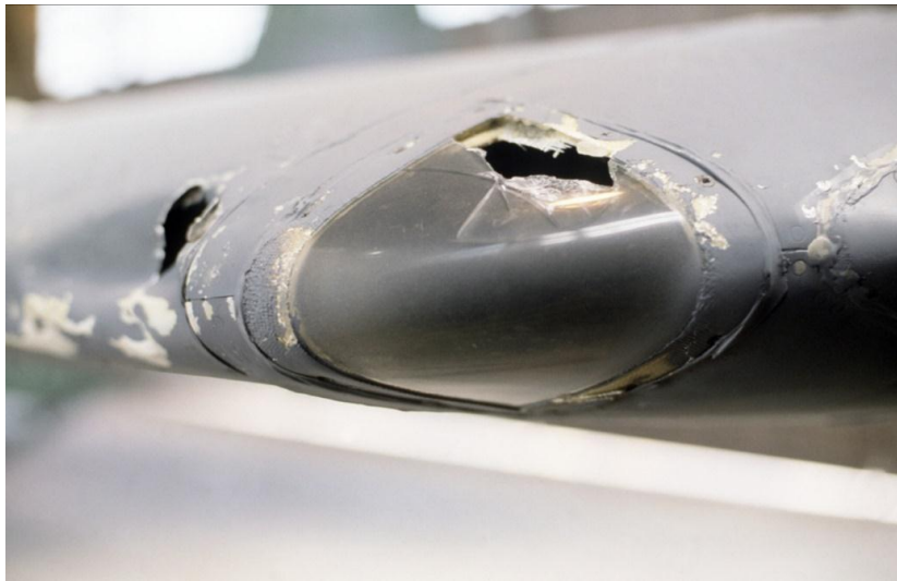
Рисунок 2.8 – Приклад пошкодження закінцівки крила літака
