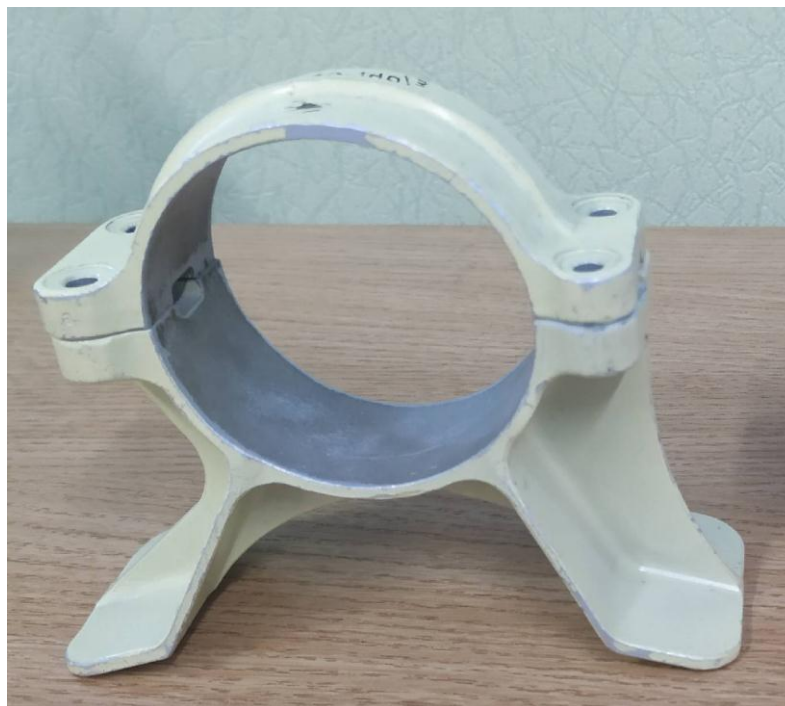
Рисунок 2.11 – Кронштейн системи керування літака зі зношеною внутрішньою поверхнею
