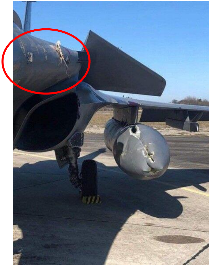
Рисунок 2.6 – Приклад пошкодження композитної накривки на передній кромці фюзеляжу літака
