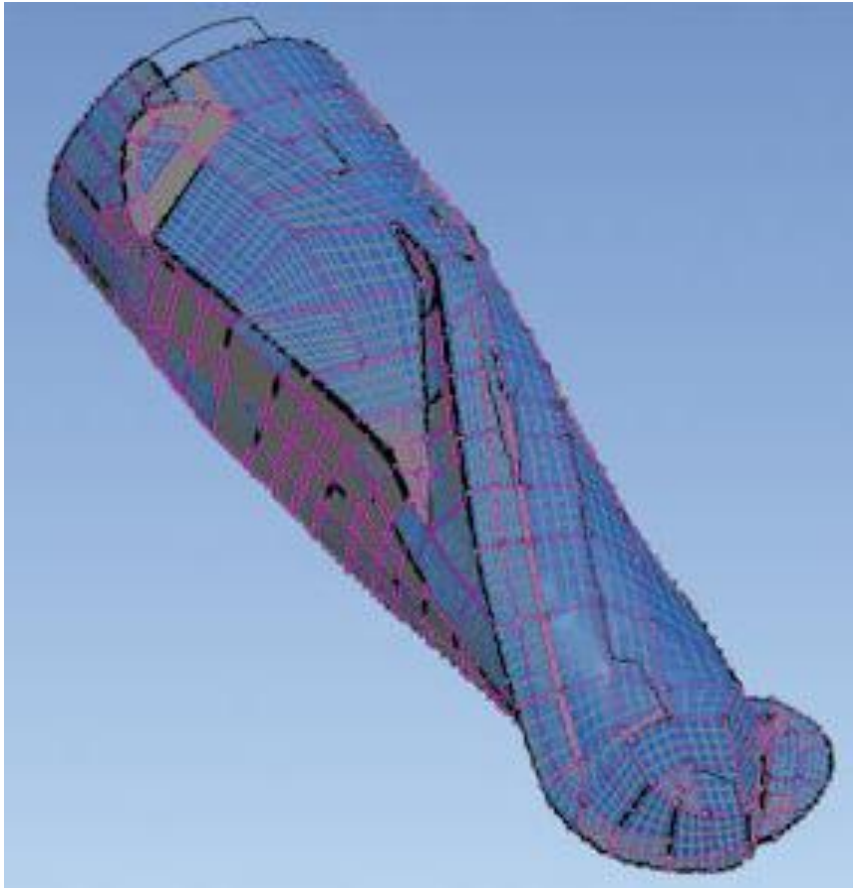
Рисунок 4.3 – Портрет геометрії фрези ( \Pi_f ) побудований за результатами вимірювань [5]
