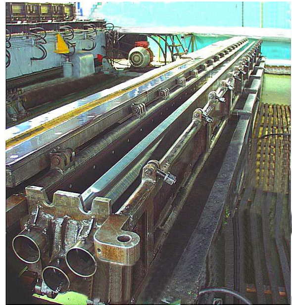
Рисунок 1.6 – Схема (а) та загальний вигляд вібростенда (б) для поверхневого зміцнення лонжерона лопаті вертольота
