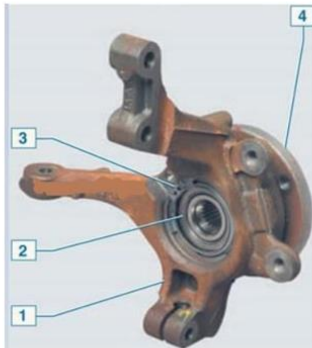
Рисунок 2.13 – Маточинний вузол переднього колеса
