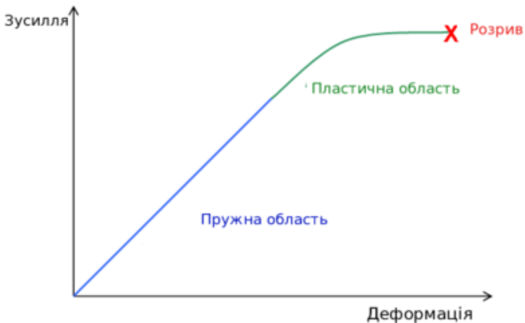
Рисунок 2.8 – Залежність деформації елемента кузова від зусилля
