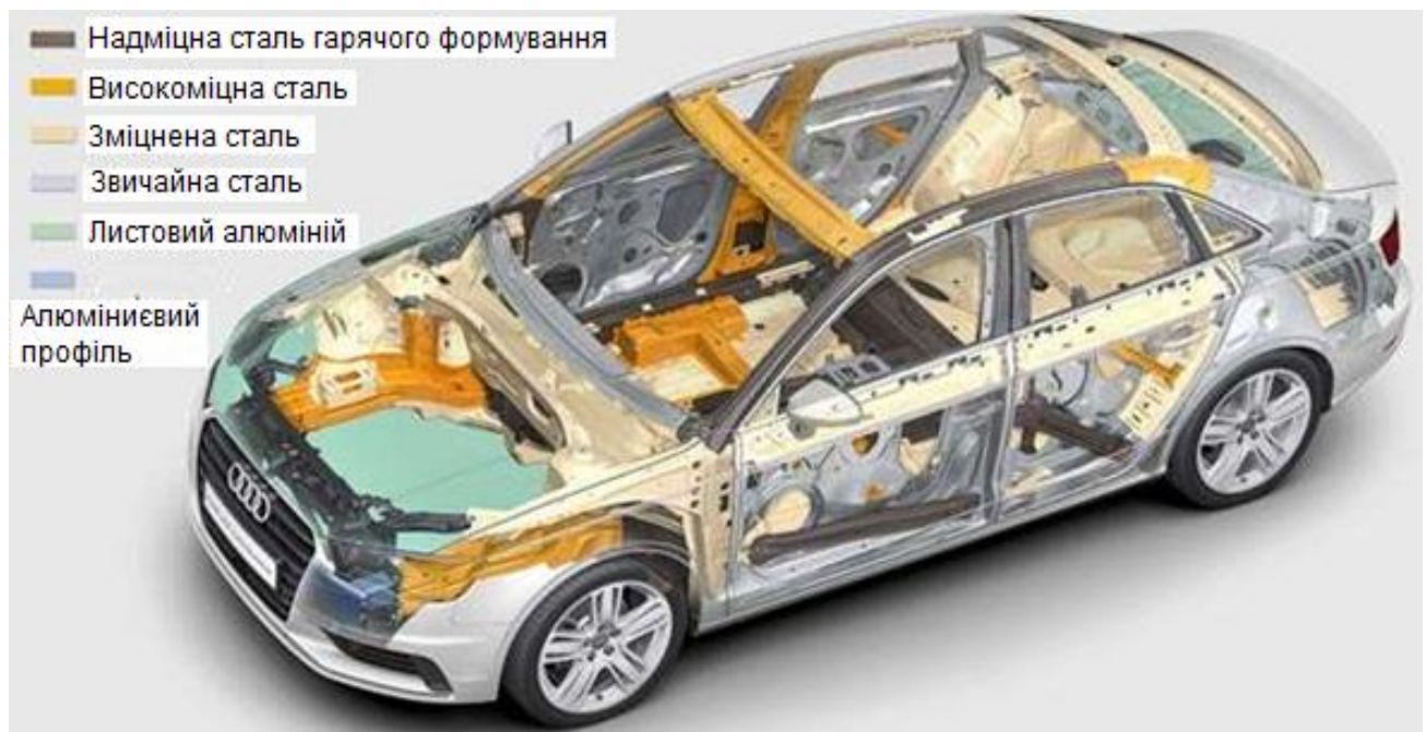
Рисунок 1.12 – Різноманітні матеріали в кузові автомобіля
