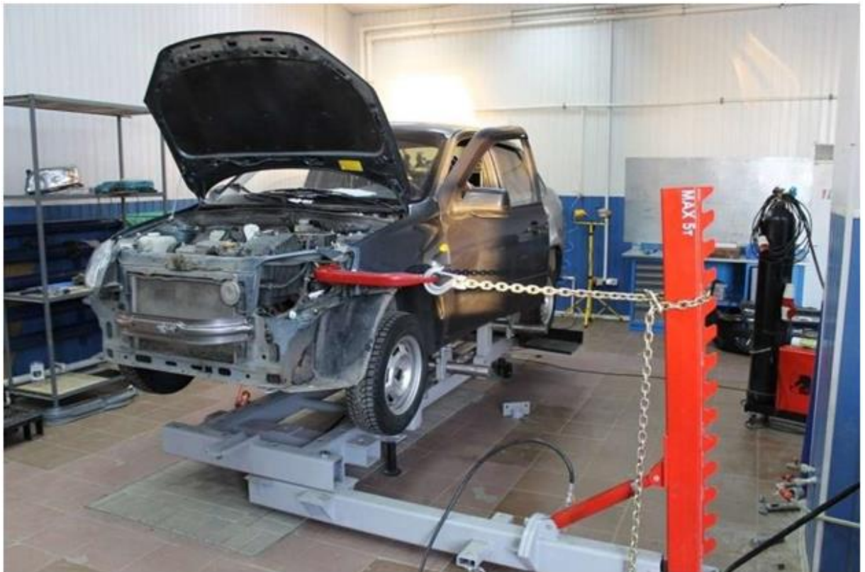
Рисунок 3.1 – Приклад розташування автомобіля на стапелі під час виконання рихтувальних робіт
