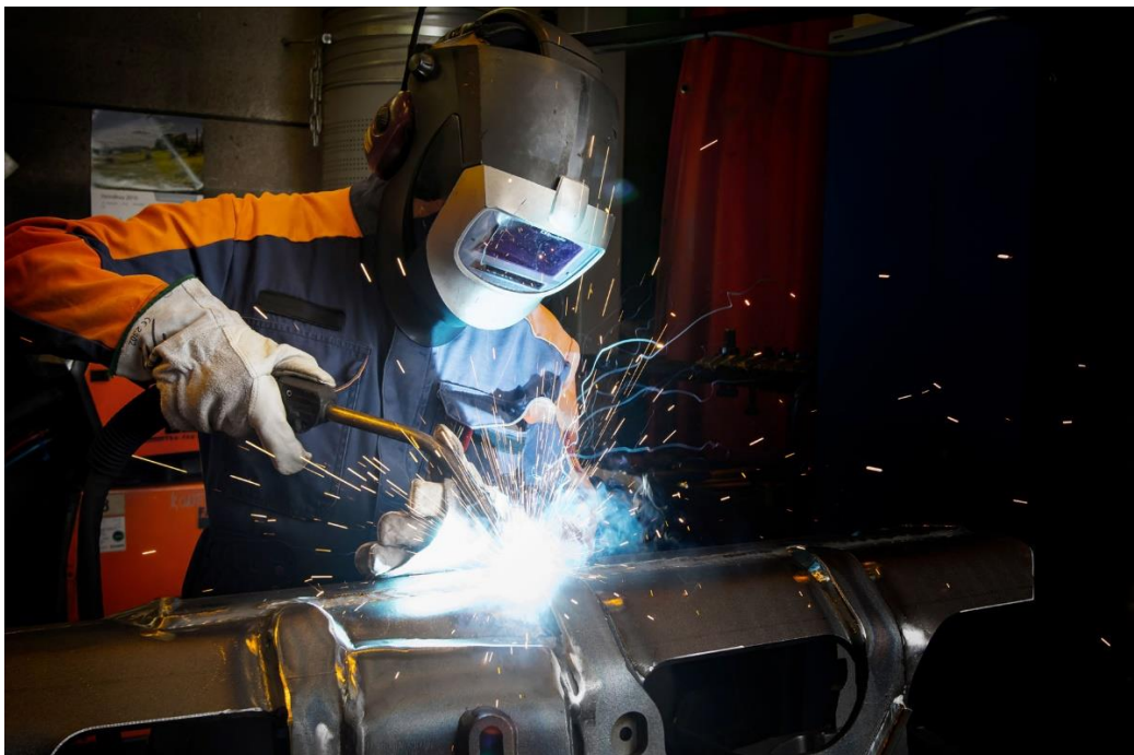
Рисунок 4.1 – Виконання зварювальних робіт кузова автомобіля
