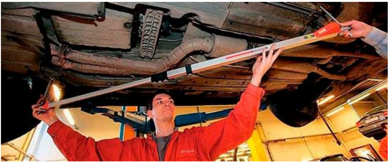
Рисунок 3.15 – Приклад контролю геометрії кузова за допомогою вимірювальної лінійки
