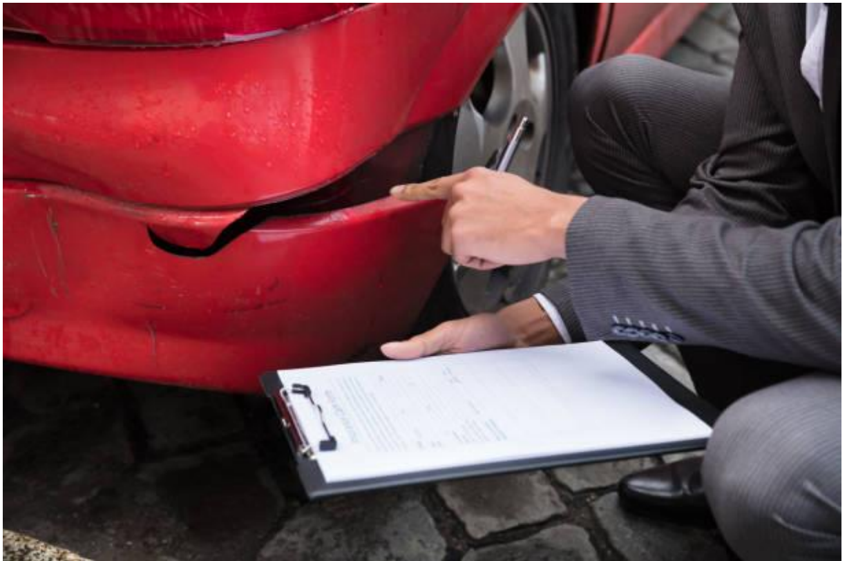
Рисунок 2.5 – Огляд дефекту на бампері
