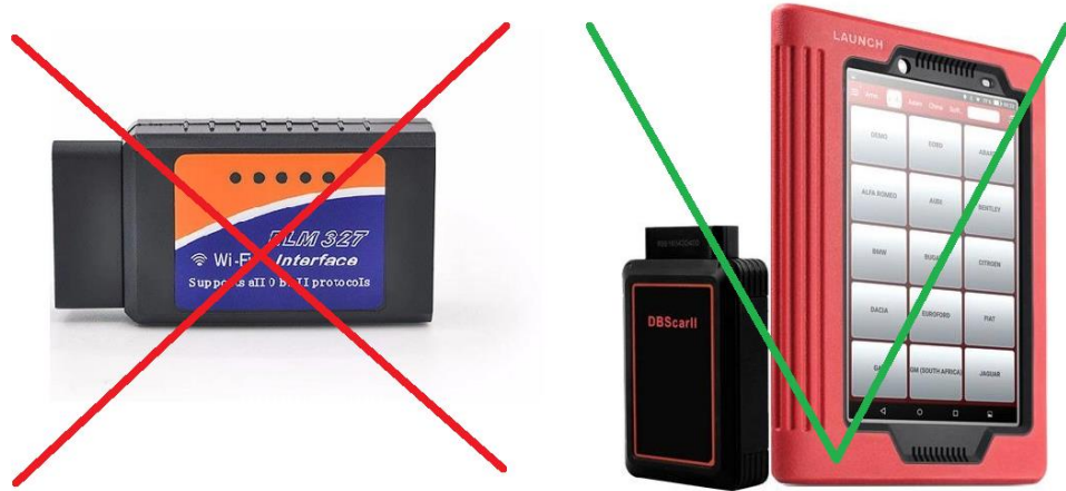
Рисунок 3.10 – OBD сканери різного покоління
