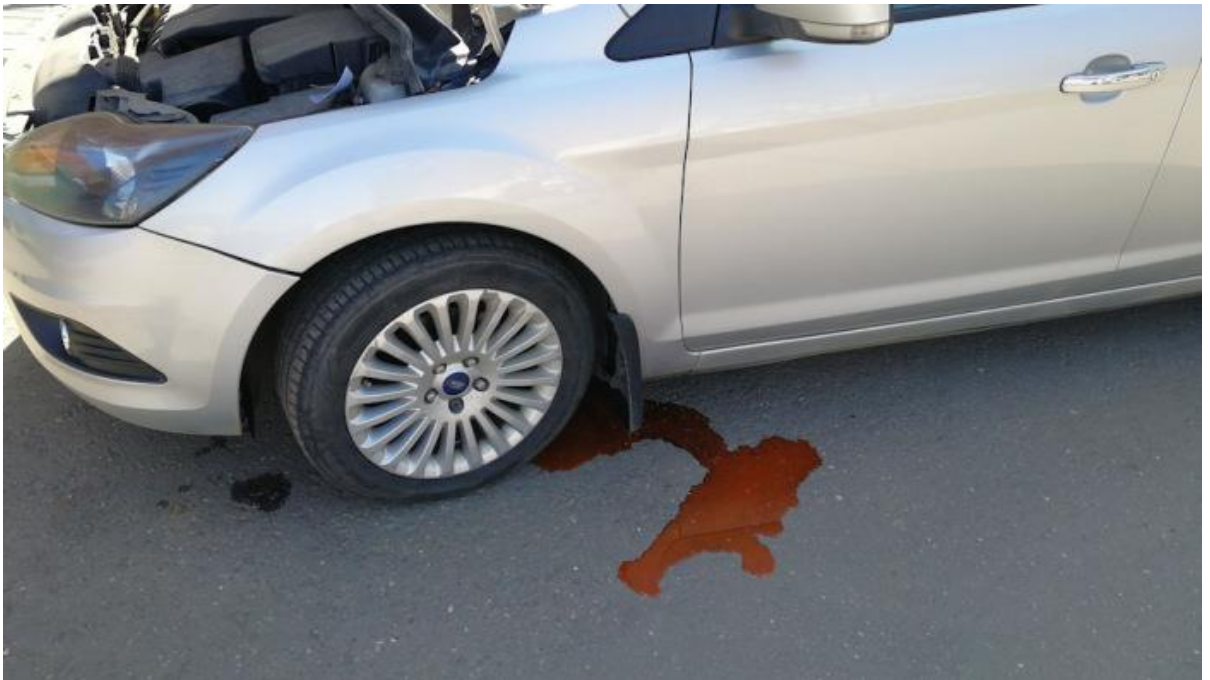
Рисунок 2.8 – Авто з пошкодженою системою охолодження
