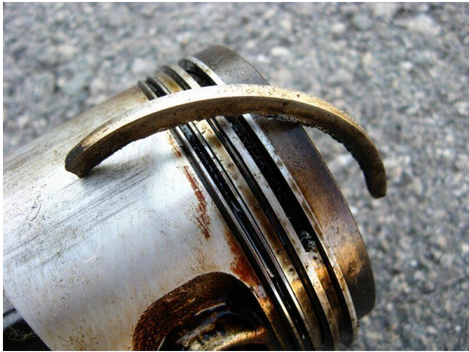
Рисунок 2.5 – Зламане компресійне кільце
