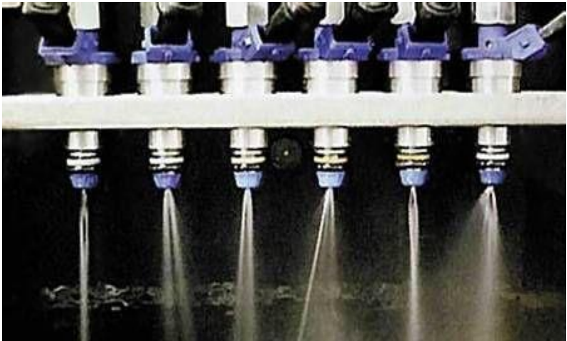
Рисунок 2.7 – Погано працюючі паливні форсунки через забрудненість паливної системи
