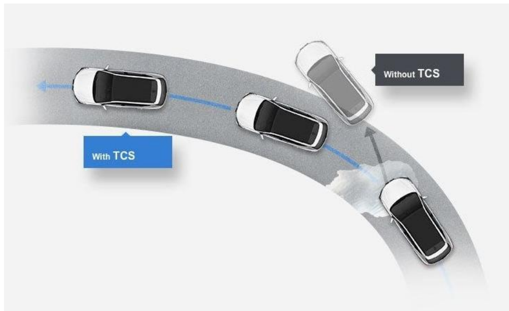
Рисунок 1.10 – Принцип роботи TCS
