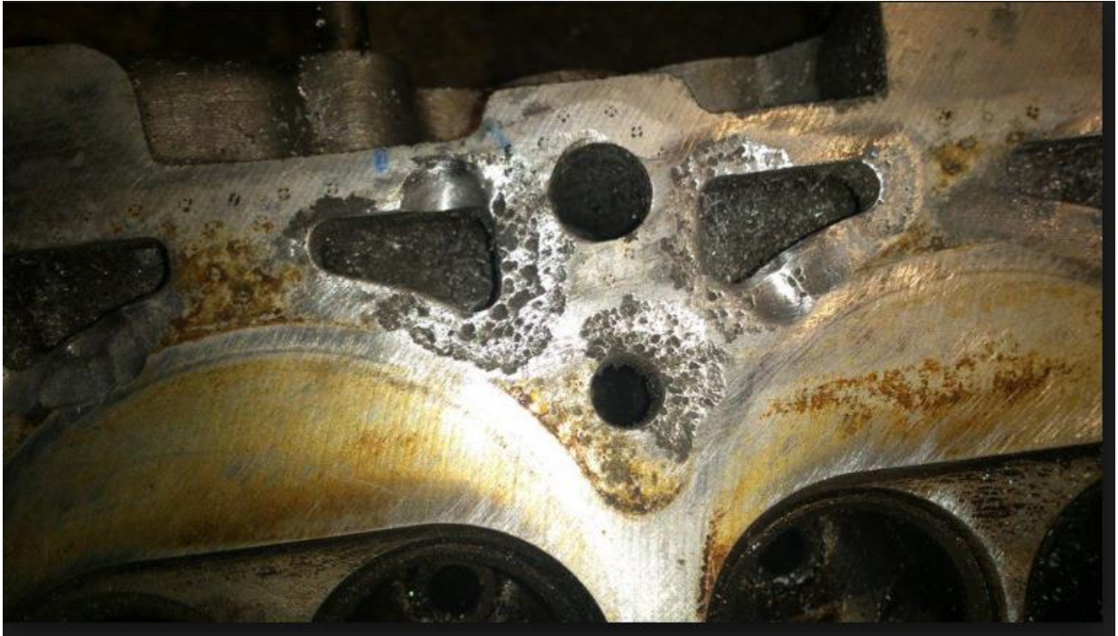
Рисунок 2.10 – Корозія на головці блока циліндрів
