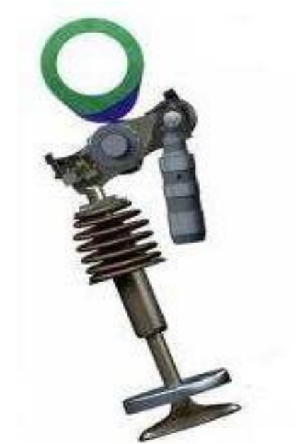
Рисунок 14 – Система механічного приводу з гідравлічним регулятором
