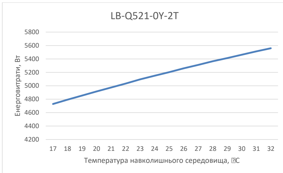
Рисунок 4.4 – Змінення споживаної потужності компресорно-конденсаторного блоку в залежності від температури навколишнього середовища
