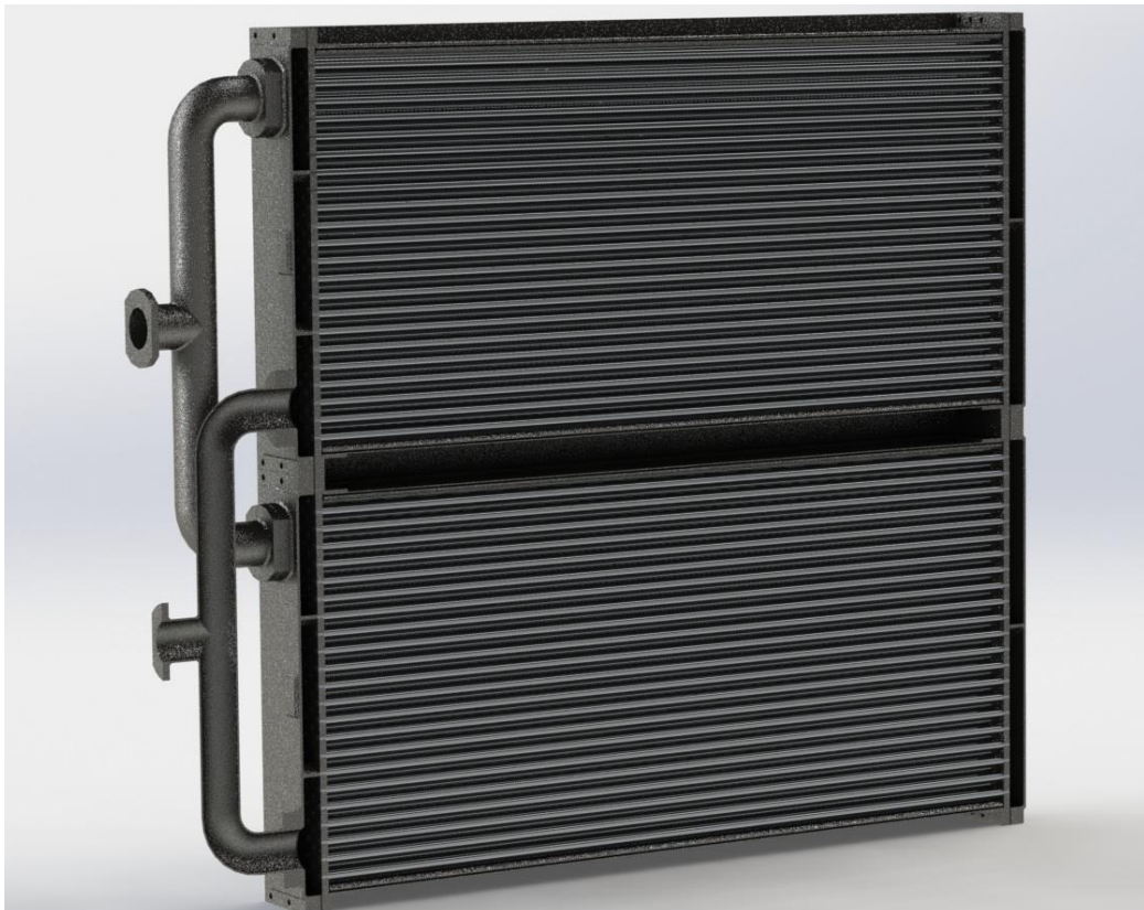
Рисунок 3.2 – Спрощена модель спроектованого газоохолоджувача (розріз)
