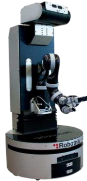
Рисунок 1.13 – Мобільний маніпулятор RB-1
