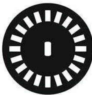
Рисунок 3.13 – Диск із прорізами із чорного оргскла для оптичного датчика
