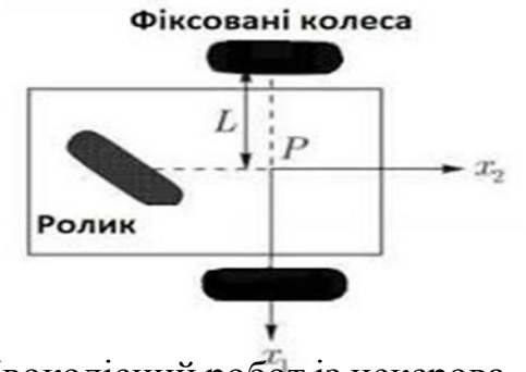
Двоколісний робот із некерованим третім колесом
