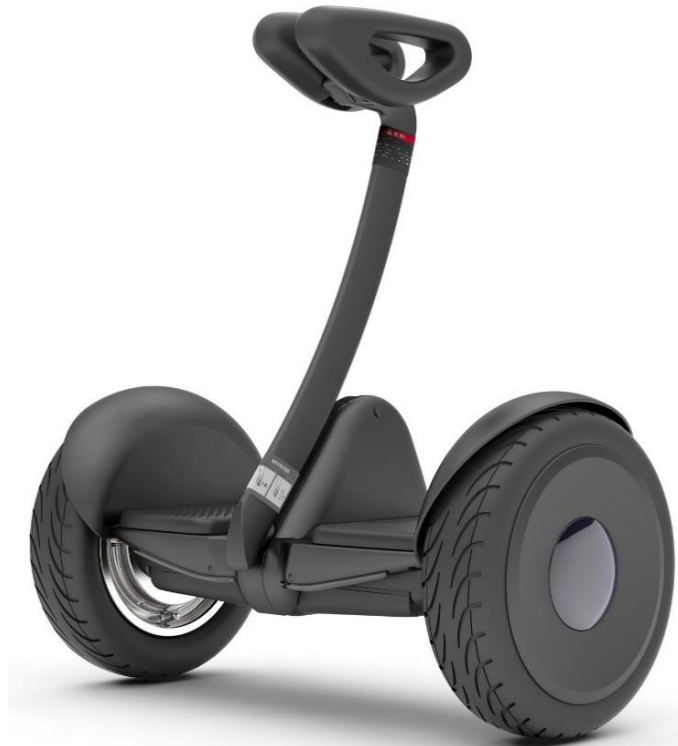
Рисунок 1.5 – Двоколісний балансуючий робот
