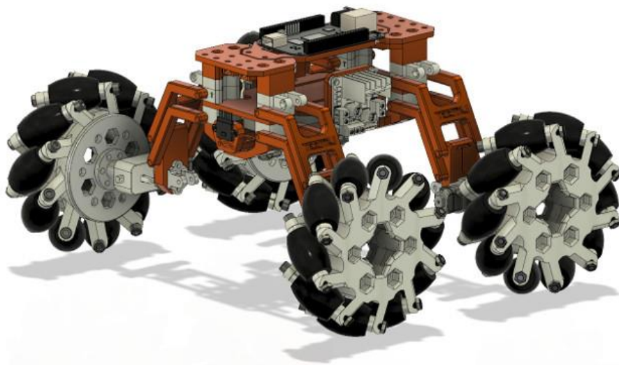
Рисунок 1.17 – Реалізований приклад чотириколісного робота з чотирма активними фіксованими шведськими колесами.
