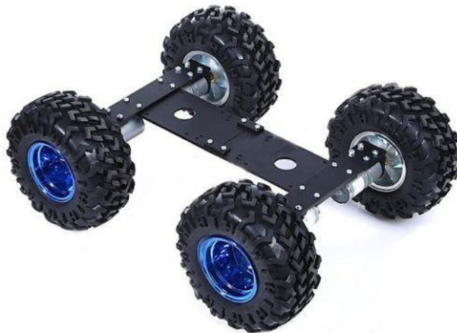
Рисунок 1.15 – Реалізований приклад чотириколісного робота з чотирма активними фіксованими колесами.
