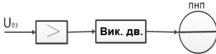
Рисунок 2.8 – Функціональна схема блока управління положенням горизонтальної стрілки ПНП
