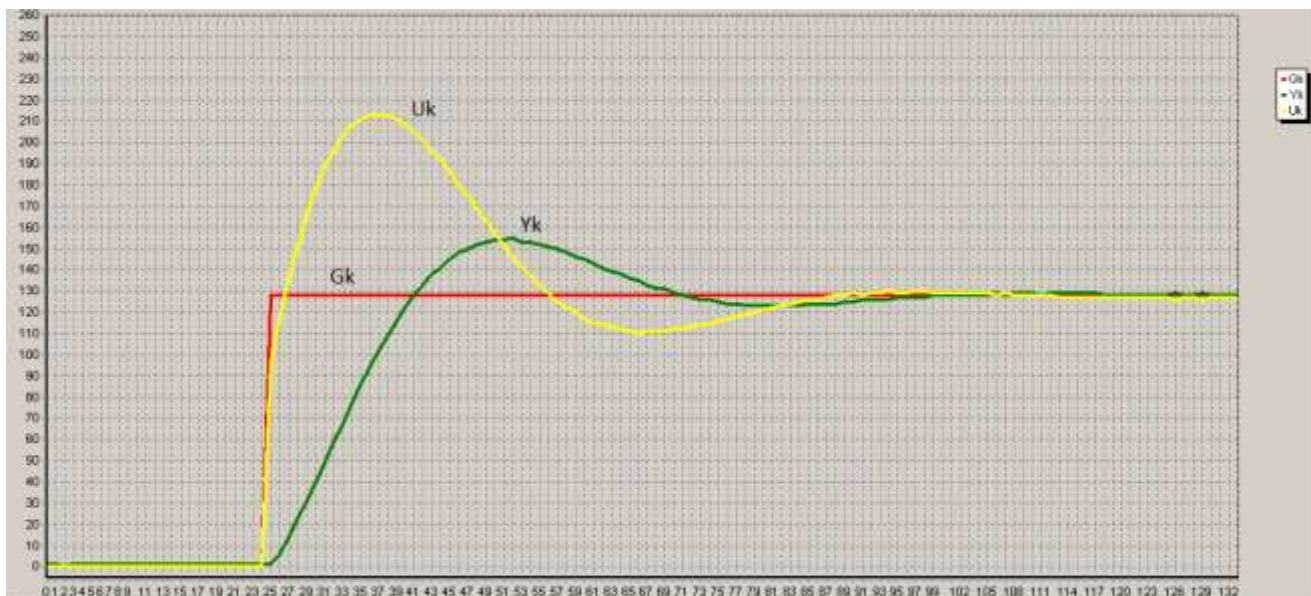
Рисунок 5.7– Перехідний процес у системі стабілізації кутової швидкості за задавальним впливом ( U_k – сигнал управління від контролера, G_k – задавальний сигнал, Y_k – вихідний сигнал ОАУ, тобто керований параметр)
