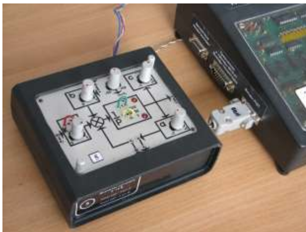
Рисунок 5.4 – Підключення модуля «Модель ОАУ» до контролера УНМС
