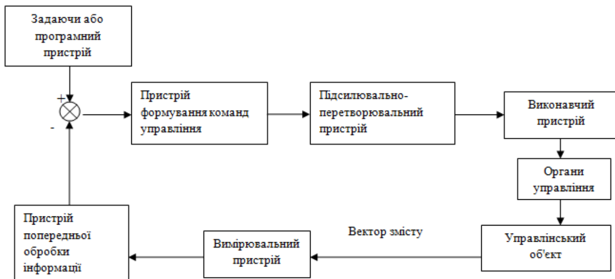
Рисунок 1.6 – Типова функціональна схема системи управління
