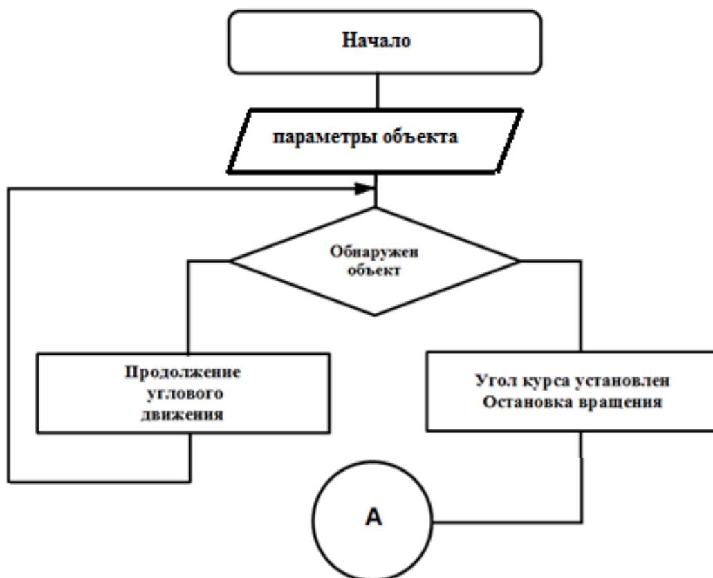
Рисунок 5.3 – Зображення алгоритму пошуку предмета орієнтування
