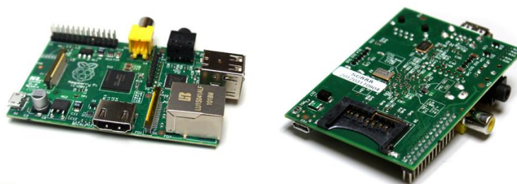
Рисунок 3.6 – Зовнішній вигляд мікроконтролер ного обчислювача «Raspberry Pi»
