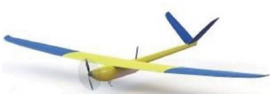
Рисунок 1.1 - Класична схема з тягнучим гвинтом
