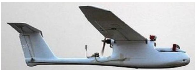
Рисунок 1.2 - Класична схема зі штовхальним гвинтом
