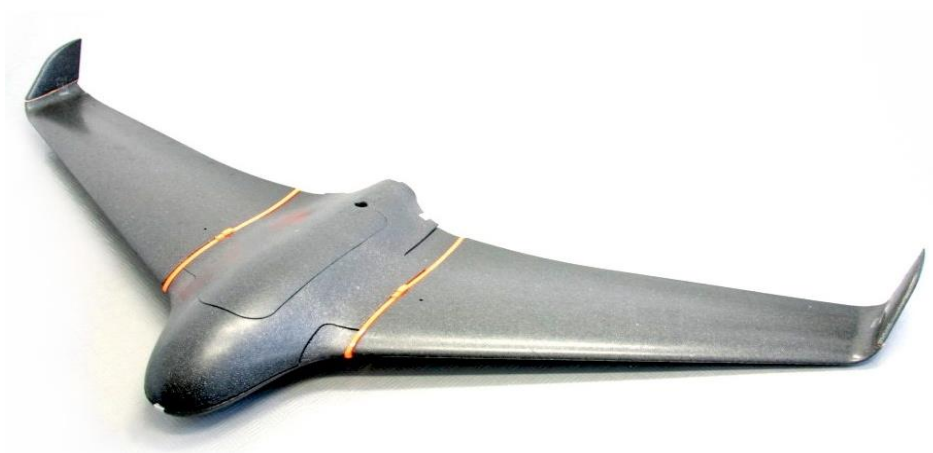
Рисунок 1.3 - Літаюче крило зі штовхальним гвинтом
