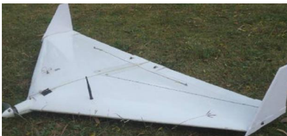
Рисунок 1.4 - Літаюче крило з тягнучим гвинтом
