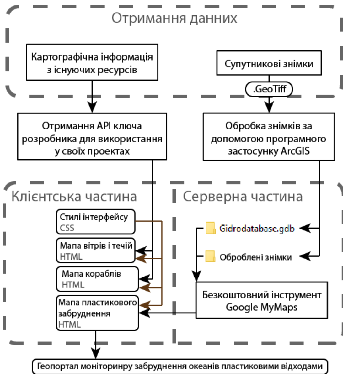
Рисунок 3.2 – Принцип роботи WEB-візуалізатора
