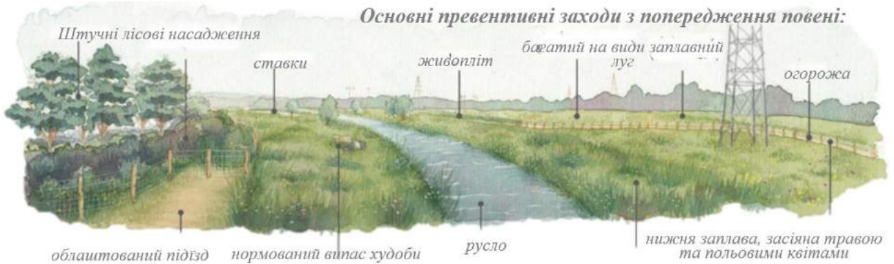
Рисунок 2.9 – Приклад облаштування річної долини з метою попередження повені
